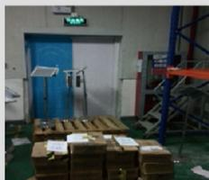
综合仓库将生产原材料堵住安全门,在紧急情况下不便于应急逃生。
