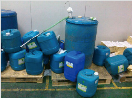
1.各料间助焊剂桶摆放凌乱，酒精桶随意放置。
