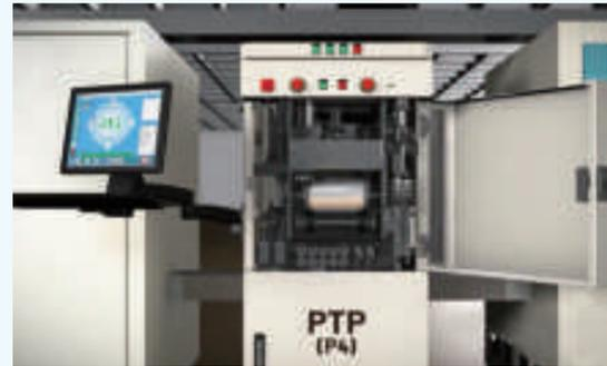
使用其已经申请专利的光诱导沉积技术，PTP技术能够3D打印出25微米宽、15微米高的结构，增加了太阳能电池的效率，但仍然使用与其它工艺相同的基本材料。该公司声称，对于一条标准的40MW光伏生产线，新的3D打印工艺将每年节省高达50万美元的银浆成本，并可由于效率提升获得额外50万美元效益。他们甚至保证其设备投资成本可在6个月内完全收回。
