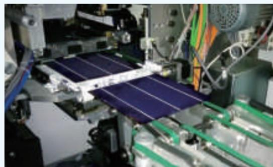
Utilight介绍了他们的技术优势：“Utilight的方法不需要改变现有的生产线，只需以最小的投资添加一个模块，即可节约高达70%的银浆和增加0.4%的效率。通过PTP打印机，硅晶片结构发生了巨大的变化——打印的银线的数量大幅增加而它的尺寸却在减小。”
