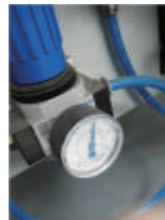
图中所示为吹纸所用的压缩空气的气源压力。标定值为0.6MPa。
