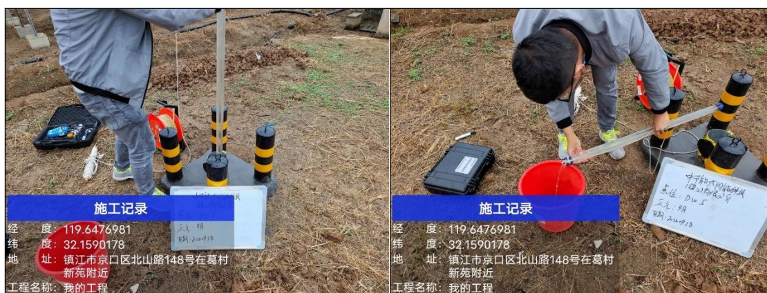
图7.2-3 地下水洗井照片
