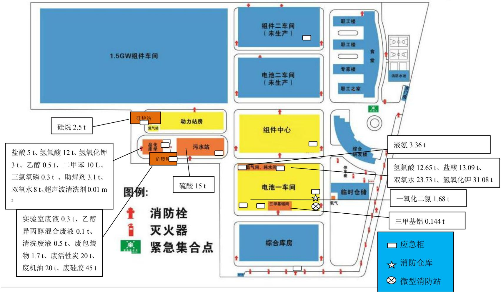
图 7 污染物内部控制示意图
