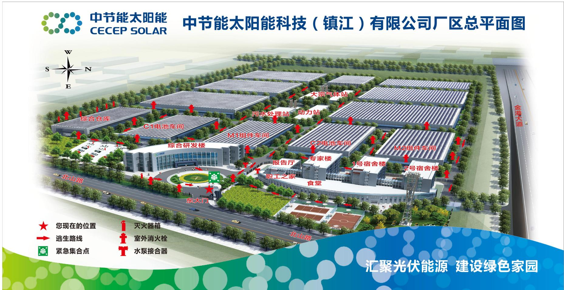
图2 厂区平面布置及逃生路线图
